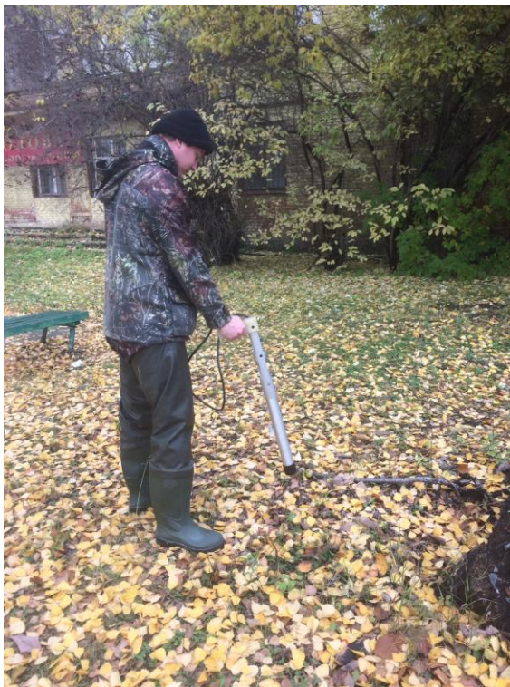
Рис.3. Проведение экологических исследований: измерение мощности дозы гамма-излучения с поверхности почвы
