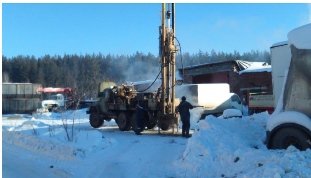
Рис.2. Бурение установкой УРБ-2А2 на промышленной площадке
